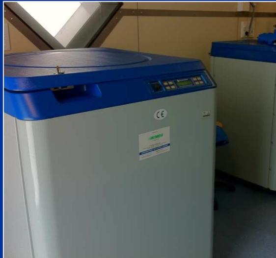
Le corrette condizioni di stoccaggio devono essere assicurate da un sistema di riempimento automatico e di allarmi remotizzati
